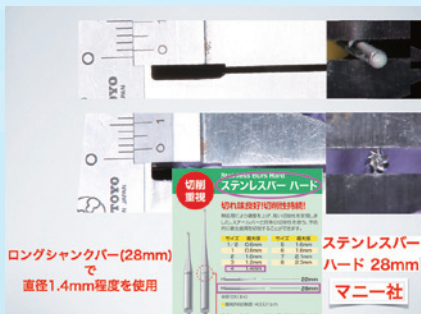
図4 セラカル PT に付属しているシリンジの直径よりも若干直径の太いラウンドバー
